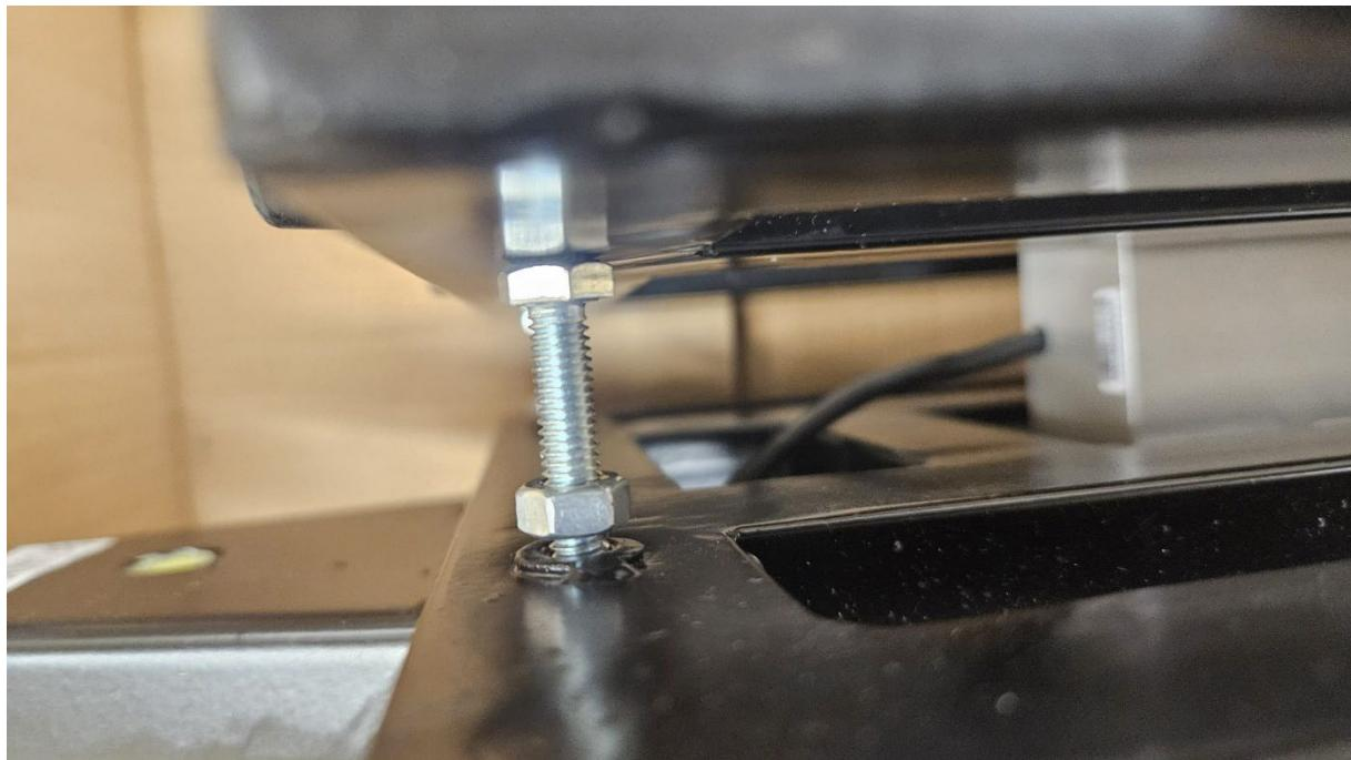
Det som visas på bilden är en transportsäkring, det är fyra skruvar som sitter vid varje hörn av vågplattan. Dessa ska skruvas ner innan användning, annars kommer vågen visa felaktigt. De kan fortfarande sitta kvar, så länge det är avstånd mellan skruvorna och vågplattan.
